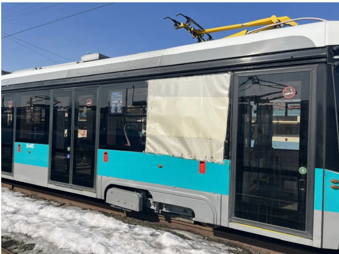
Рис. 5. Трамвайный вагон бортовой номер 345. Разбито стекло салона.
