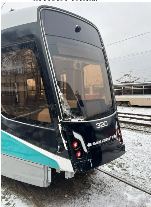
Рис. 4. Трамвайный вагон бортовой номер 320. Повреждение кузова и заднего стекла салона.
