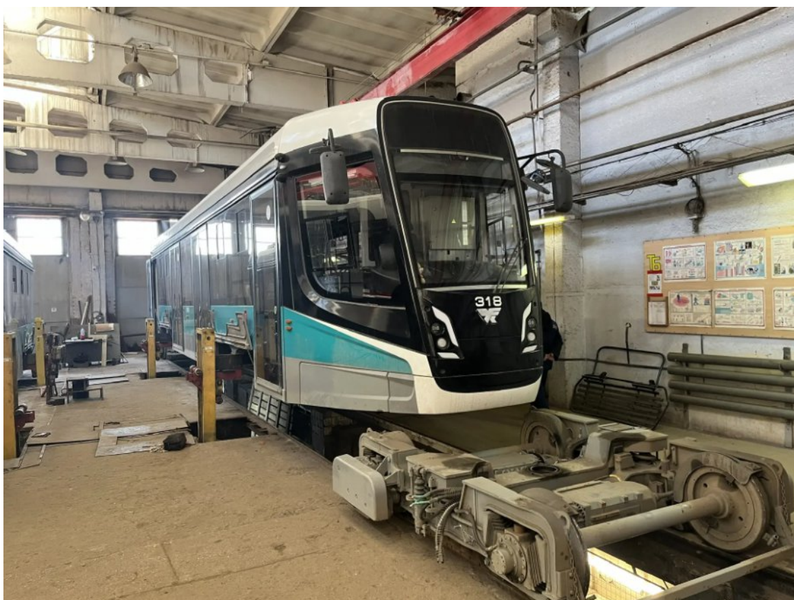
Рис. 6. Трамвайный вагон бортовой номер 318. Замена подшипников шкворней 1-ой тележки.
