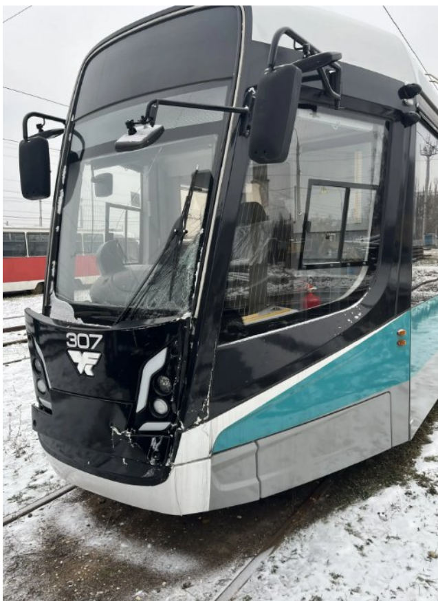
Рис. 3. Трамвайный вагон бортовой номер 307. Повреждение кузова и лобового стекла.
