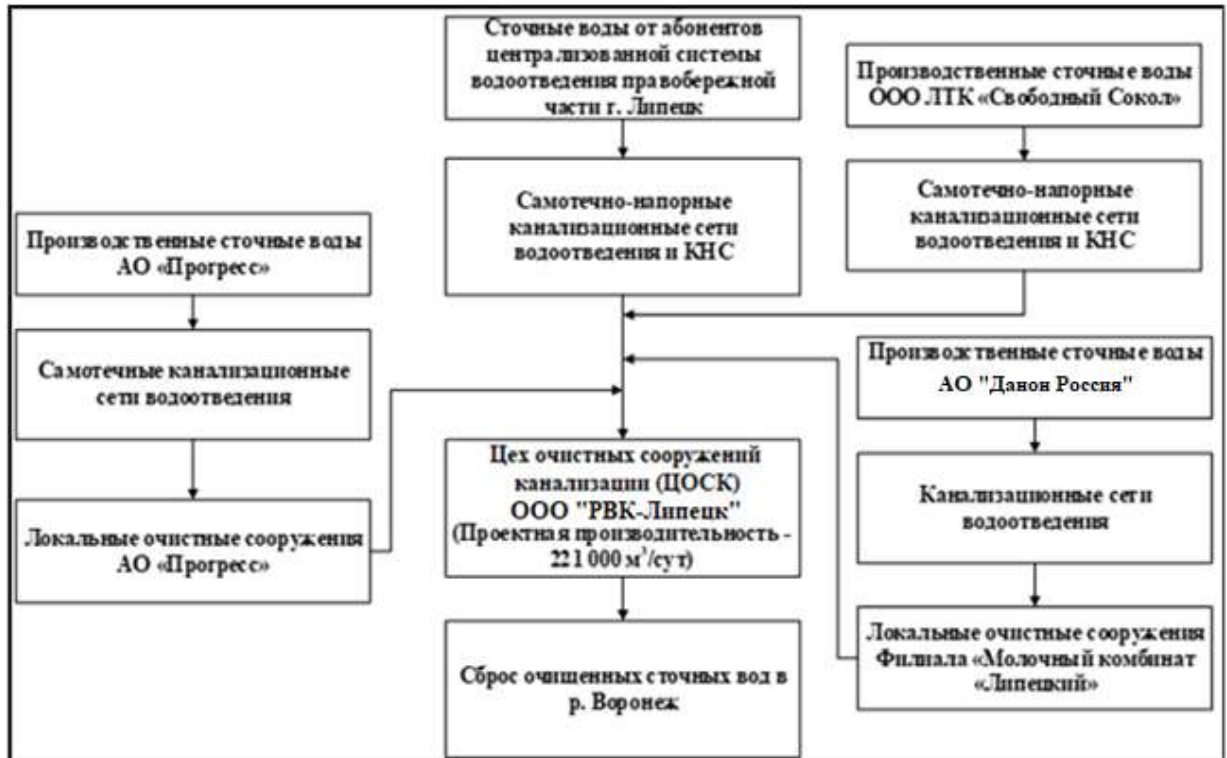
Рисунок 1.1.1 – Структурная схема централизованного хозяйственно-бытового водоотведения правобережной части г. Липецка
