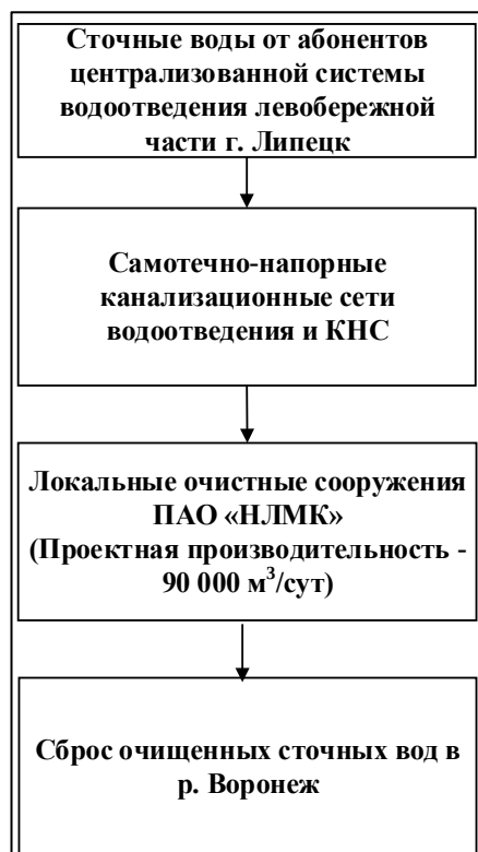
Рисунок 1.1.2 – Структурная схема централизованного хозяйственно-бытового водоотведения левобережной части г. Липецка
